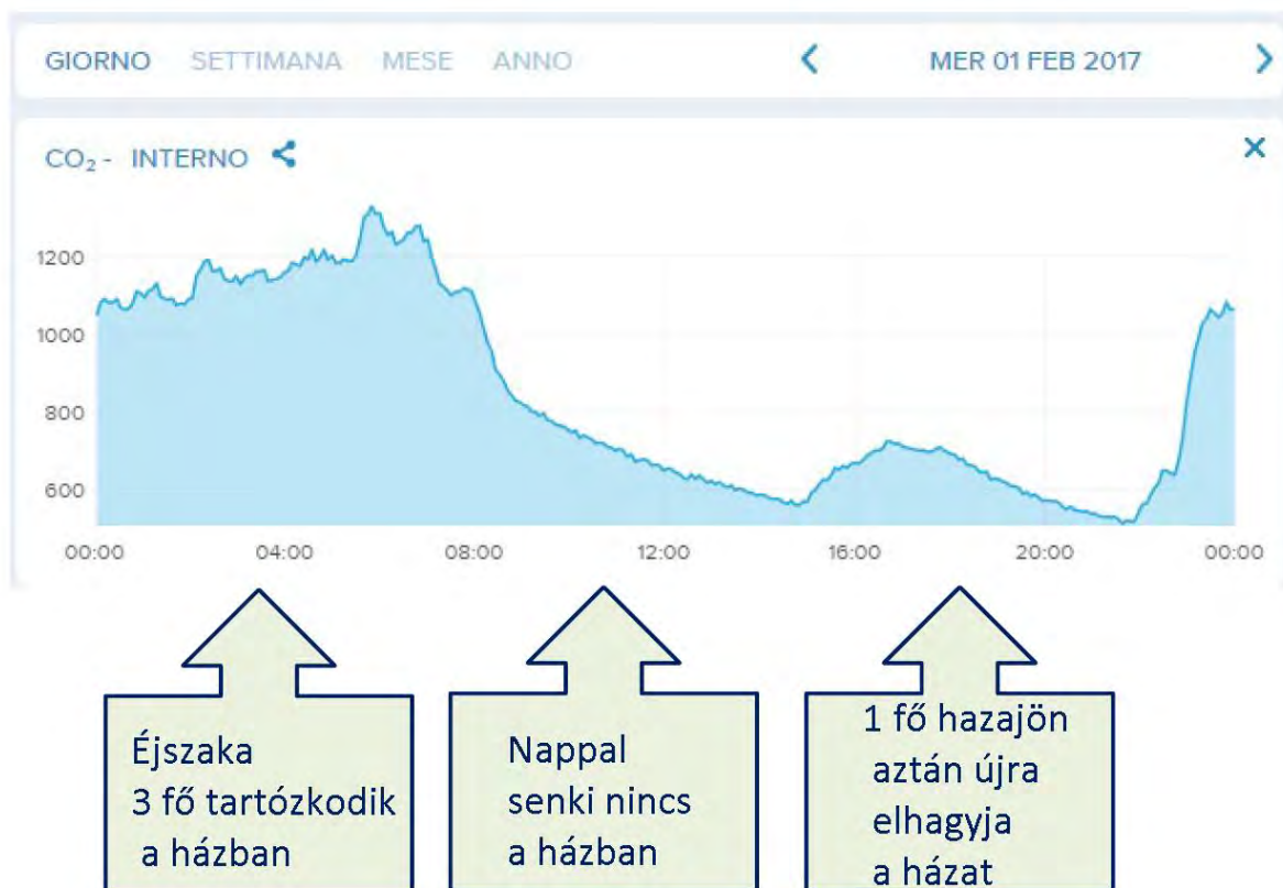
3.8. ábra. A szén-dioxid koncentráció napi alakulása egy lakásban (Laurent Socal BUILD UP Webinar series Webinar 4: EPB standards hourly vs monthly methods 26 May 2020)
